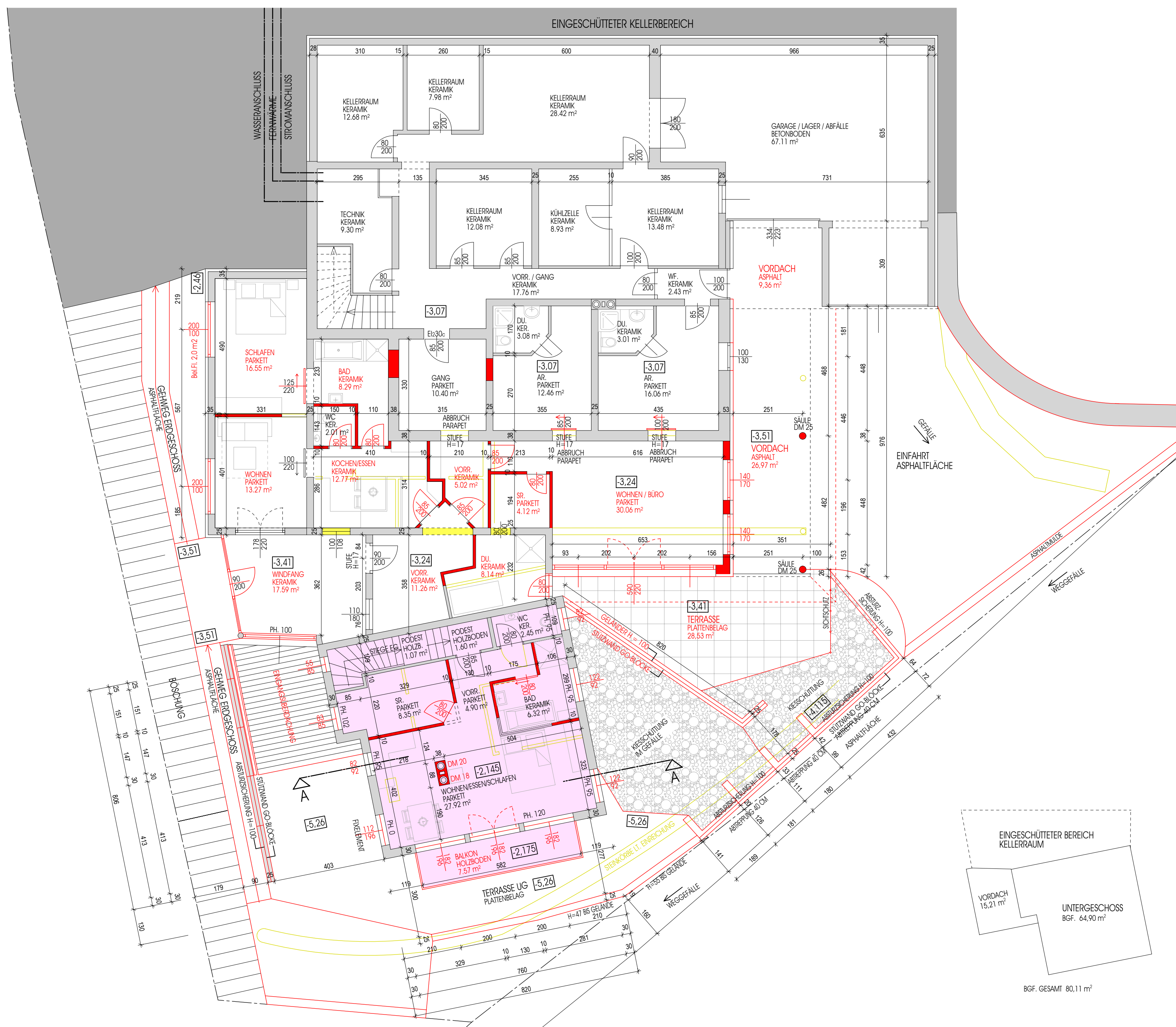
ERDGESCHOSS 1/100 BRUTTOGESCHOSSFLÄCHE 277,80 m² BEBAUFLÄCHE 277,80 m² NUTZFLÄCHE 244,47 m²
