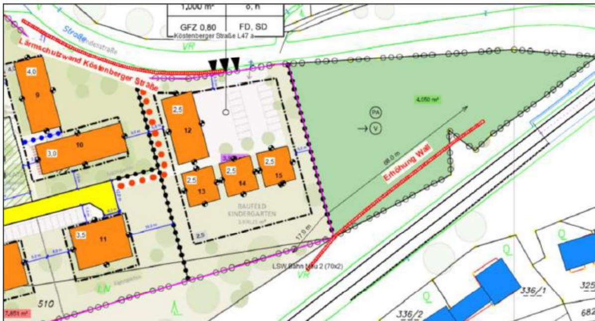
Abbildung 14: Lage Erhöhung Erdwall Bahntrasse (Quelle: DI Künstner, Lärmbüro)
