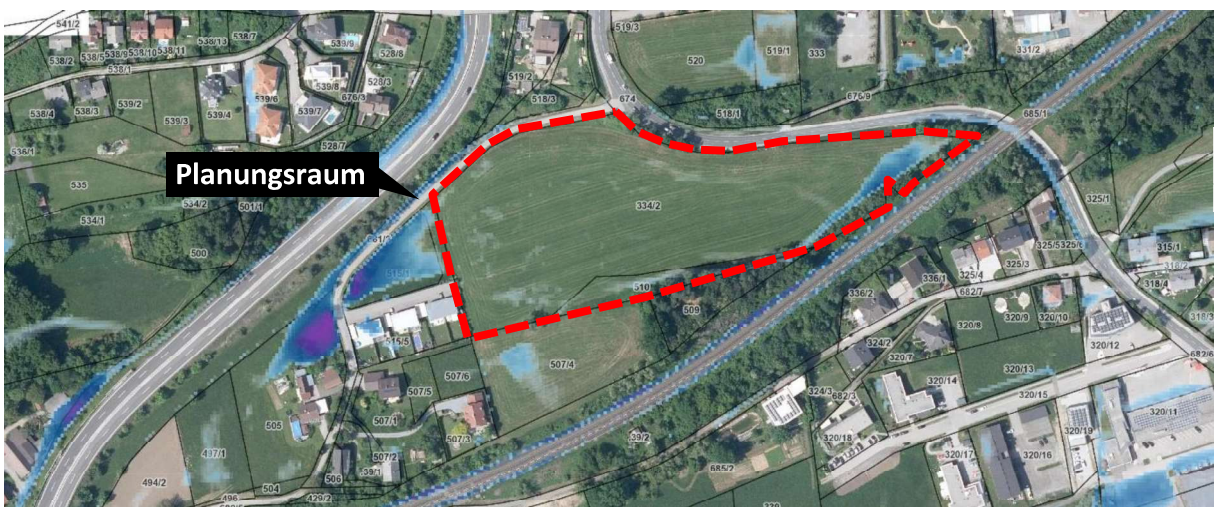
Abbildung 9: Oberflächenabfluss mit max. Wassertiefe (Quelle: KAGIS)
