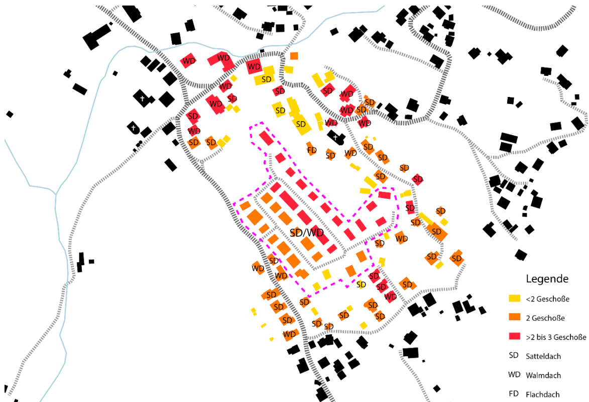
Abbildung 10: Strukturplan mit projektierten Baukörpern und Wegenetz in finaler Ausbaustufe (Quelle: eigene Darstellung auf Basis OpenStreetMap)
