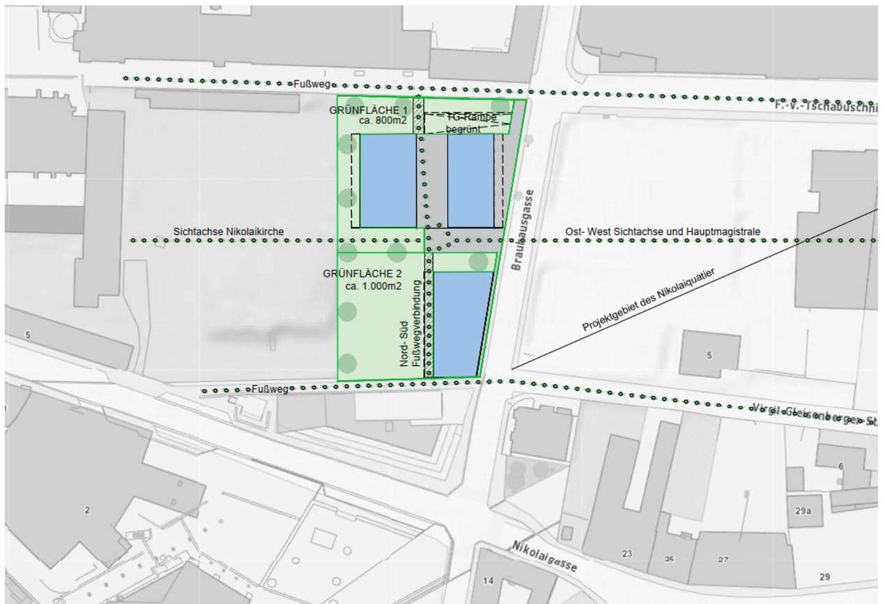
Abbildung 8: Baukörperstudie mit Grünflächen, Sichtachsen, Gehverbindungen, ohne Maßstab (Quelle: Büro KATZIANKA | architektur)
